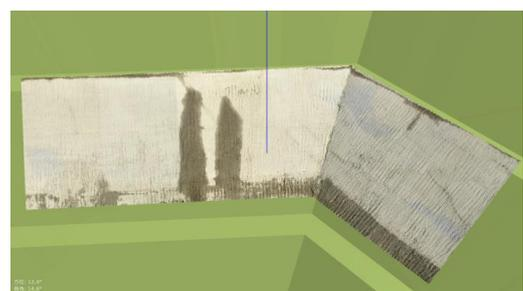
図-4 のり面地質状況写真 CIM 表示例
