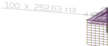
図-3 鉄筋（平均間隔）の寸法公差
