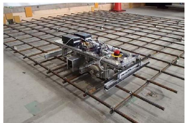
図-3 移動機構の試作機
