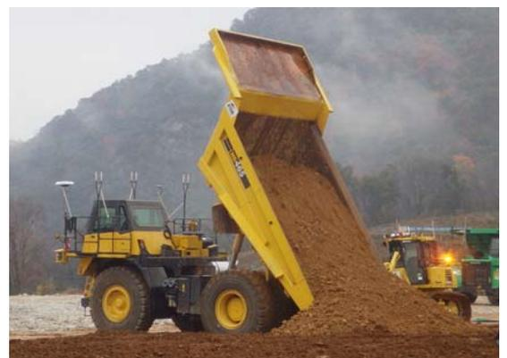
図-4 荷卸し作業と自動ブルドーザ連携
