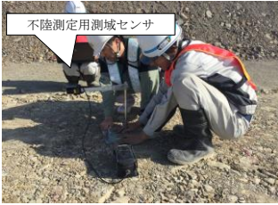
写真.5 不陸の影響試験状況
