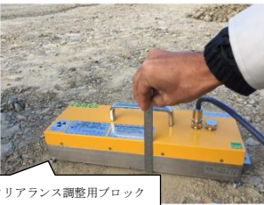
写真.4 クリアランス試験状況
