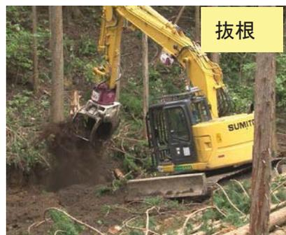
**写真-6 無人化施工システムによる伐採作業状況**
