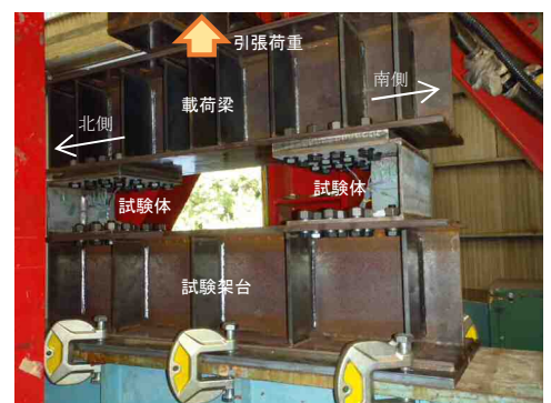
写真-3 疲労試験状況
