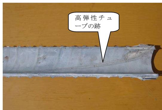
写真-5 グラウト補修材エアースタック確認
