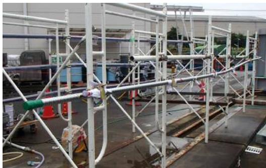
写真-2 鋼製シース試験体
