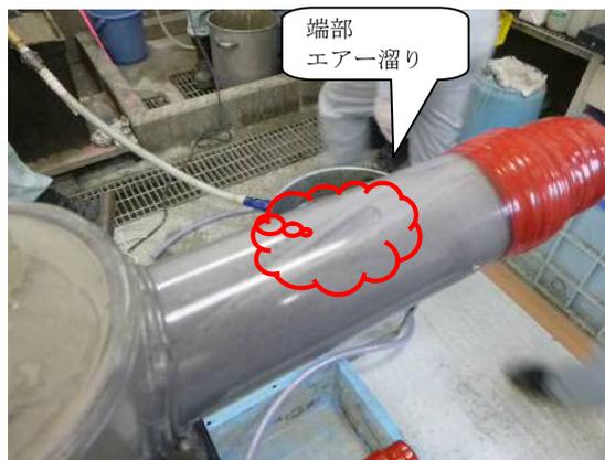
写真-4 グラウト補修材エアースタック確認
