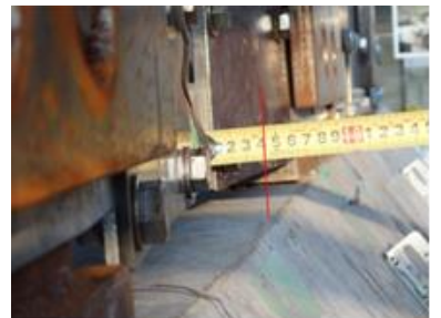
写真-4 基部コンクリート製 鋼製壁高欄実験結果 （中央部鋼製パネル前面）
