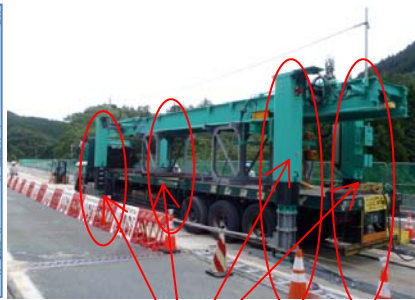
伸縮ジャッキでクレーン等を 用いず現場に仮設可能
