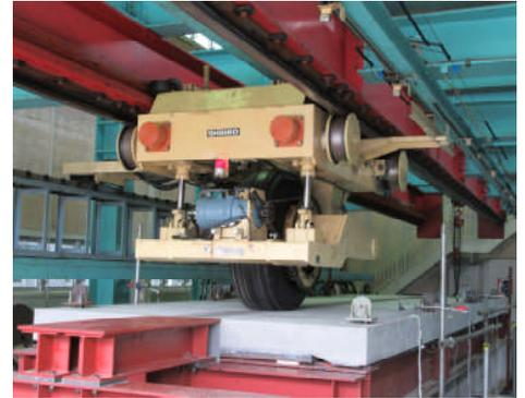
写真-1 輪荷重走行試験状況
