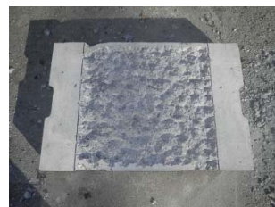
図-2 凹凸作成状況(Case3: 凹凸大)
