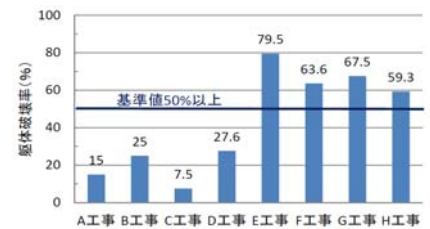
図-3 過去の工事の躯体破壊率
