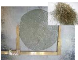
写真-3 高強度繊維補強モルタル
