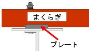
図-4 プレート挿入状況
