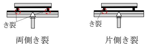
図-3 き裂が発生した溝型補強断面図
