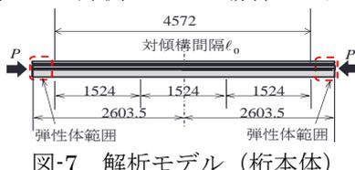
図-7 解析モデル (桁本体)
