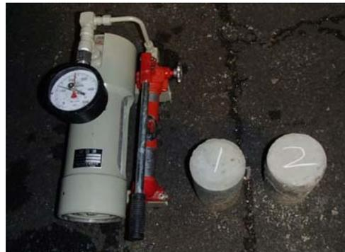
写真-3 簡易圧縮強度試験機
