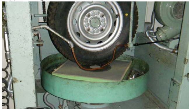
写真-2 樹脂コンのねじり骨材飛散試験状況
