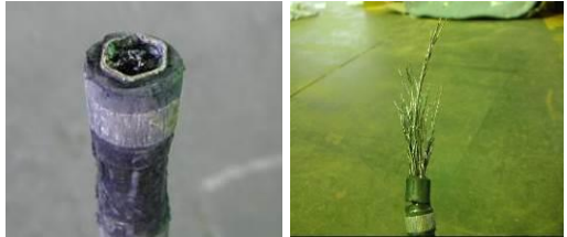
写真-1 切断破断（左）とちぎれ破断（右）
