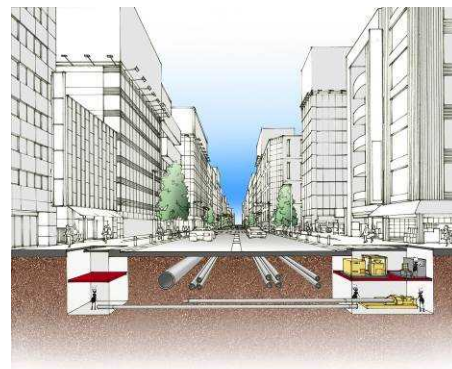
図-1 小口径推進工法施工イメージ
