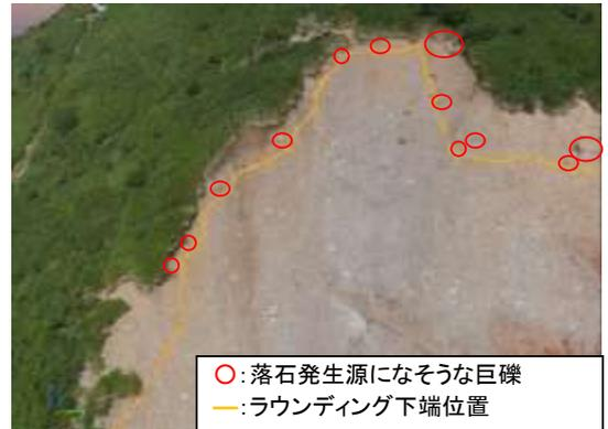
図-2 3D 地形モデルによる下端位置の設定
