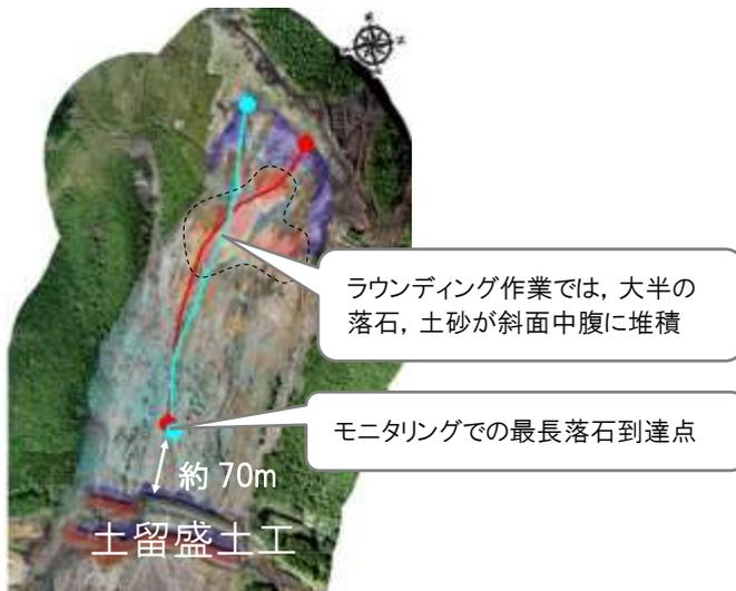
図-6 落石モニタリングの結果(落石軌跡)
