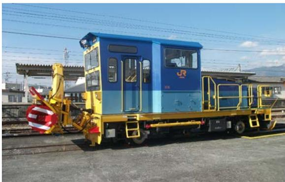
図-3 除雪装置付軌道モーターカー
