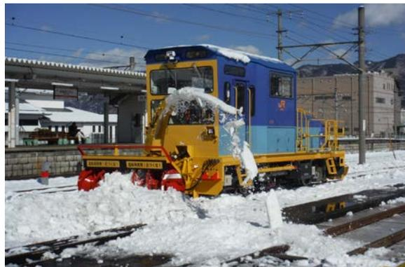
図-4 ロータリー装置による除雪試験
