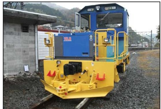
図-2 スノープラウ装置付軌道モーターカー
