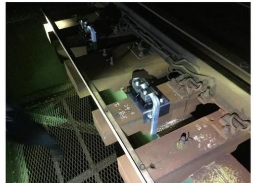
図-6 Uばね式試験敷設状況
