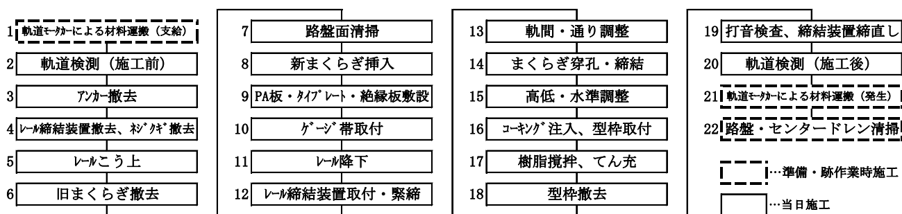
図-1 短まくらぎ合成化施工フロー
