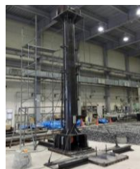
図5 落重試験装置
