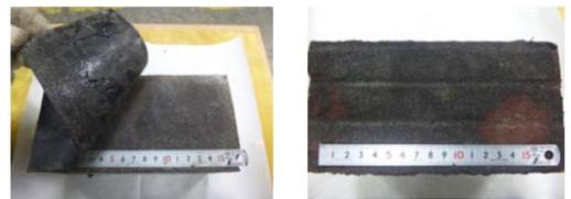
写真-2：凍結融解試験後の表面状態
