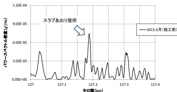
図-3 PSD 分析結果① (東北 下り 127.0k~127.4k 16Hz 128P)
