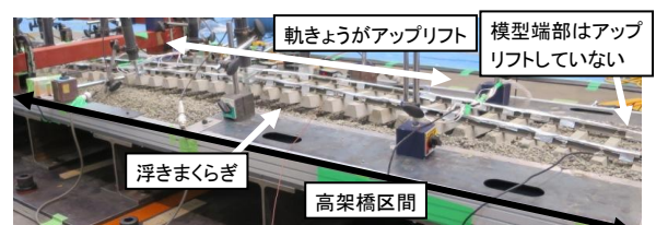
図7 高架橋区間の座屈状況
