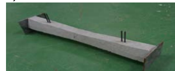
b) 座屈防止板(II(rec))付模型 3H まくらぎ 図-4 用いたまくらぎ
