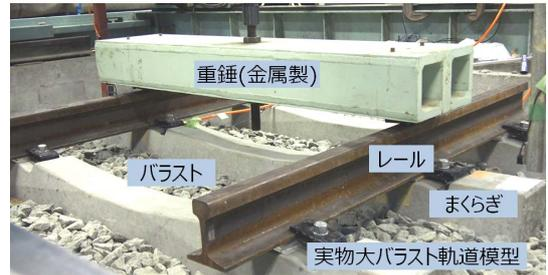
(a) 実験装置と実物大バラスト軌道模型
