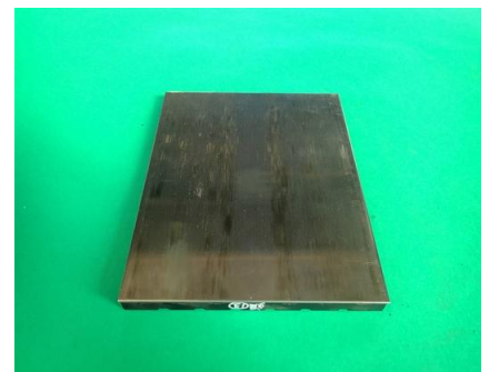
図 2 鋼板付軌道パッド（SBR 製）
