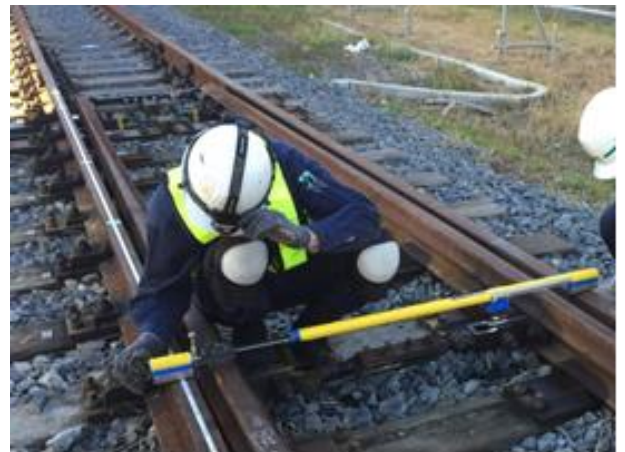
図2 軌間線寸法測定器による測定
