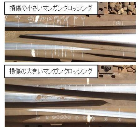
図2 試験対象マンガンクロッシング
