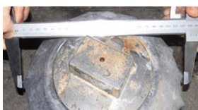
写真-2 ゲージカッター摩耗状況
