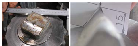
写真-3 フェイスローラービット摩耗状況
