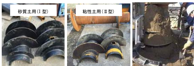
写真－5 掘削用2分割治具（Ⅰ・Ⅱ型）と掘削状況
