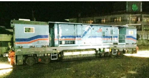
写真-2 レール削正車
