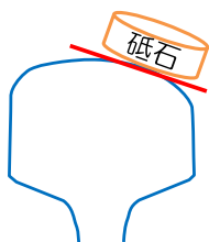
図-1 側摩耗レール
