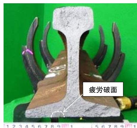
図 2 レール曲げ疲労試験結果の一例
