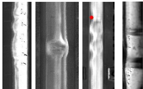
図1 対象とする不良の例 (左からきしみ割れ、シェリング、照り面の蛇行、その他 (溶接部凹凸))
