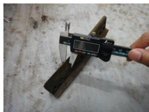
写真2 インシュレータ摩滅量測定(厚さ)
