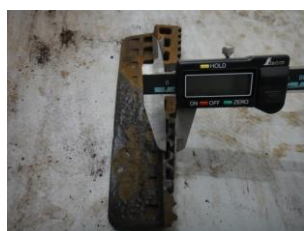
写真1 インシュレータ摩滅量測定(幅)
