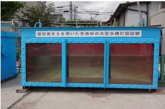
写-2 水槽打設形状（建設発生土を用いた充填材（端部））
