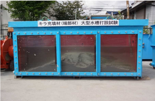
写-1 水槽打設形状（キラ充填材（端部））
