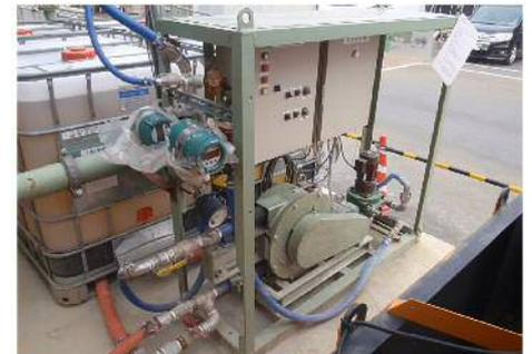
写真-2 泥水二次処理剤添加装置
