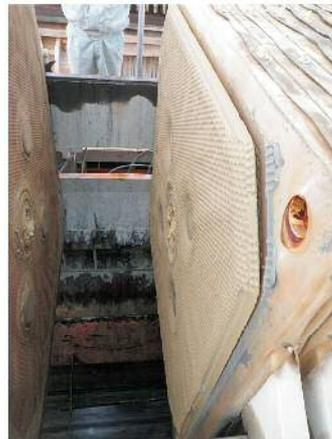
写真-4 プレス開枠時ろ布状況
