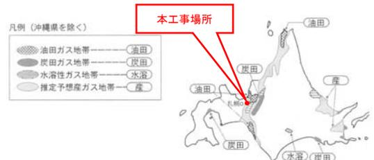
図-2 可燃性ガス分布状況<sup>2)</sup>(北海道のみ表示)
