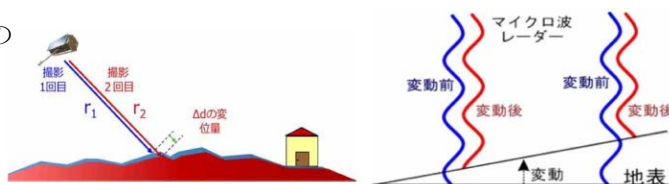
図－1 SAR 衛星の計測原理
