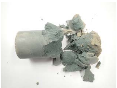
写真-3 固化後の状態
