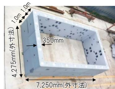
写真-1 六面鋼殻合成セグメント(2リング水平仮組み試験)
