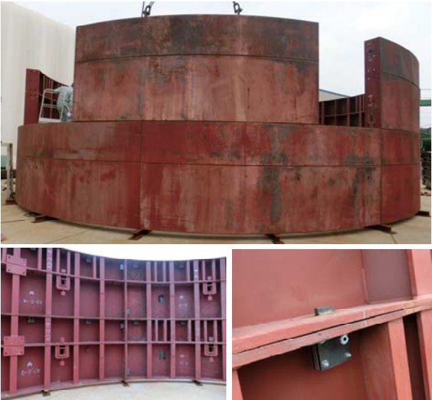
写真-1 仮組鋼製セグメントの水平仮組試験 表-1 組立時間の実績
