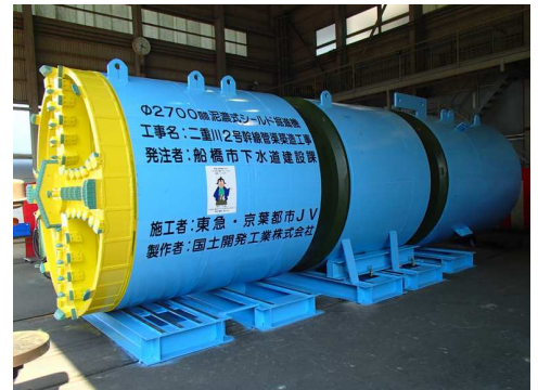
写真1 デュアルシールド工法掘進機
