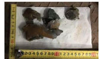
写真-1 本管切断片
