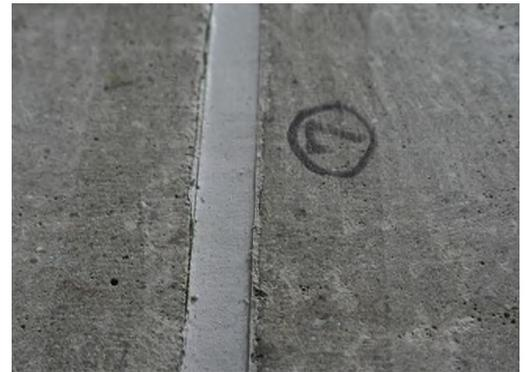
写真-2 エポキシ系止水材引掻き試験後状況
