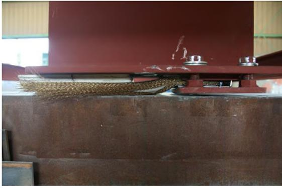
写真-1 テールブラシ引掻き試験装置
